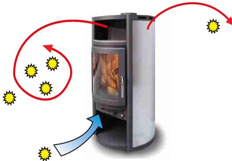
Produce aria molto calda che si secca perché il vapore acqueo si depone su corpi freddi (pareti, finestre,...)
