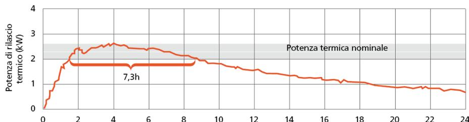
*Il metodo di collaudo SAA 142/222 consente di misurare il rilascio termico della stufa nella stanza che viene utilizzato per determinare il periodo di rilascio termico uniforme per carica di legna bruciata*
